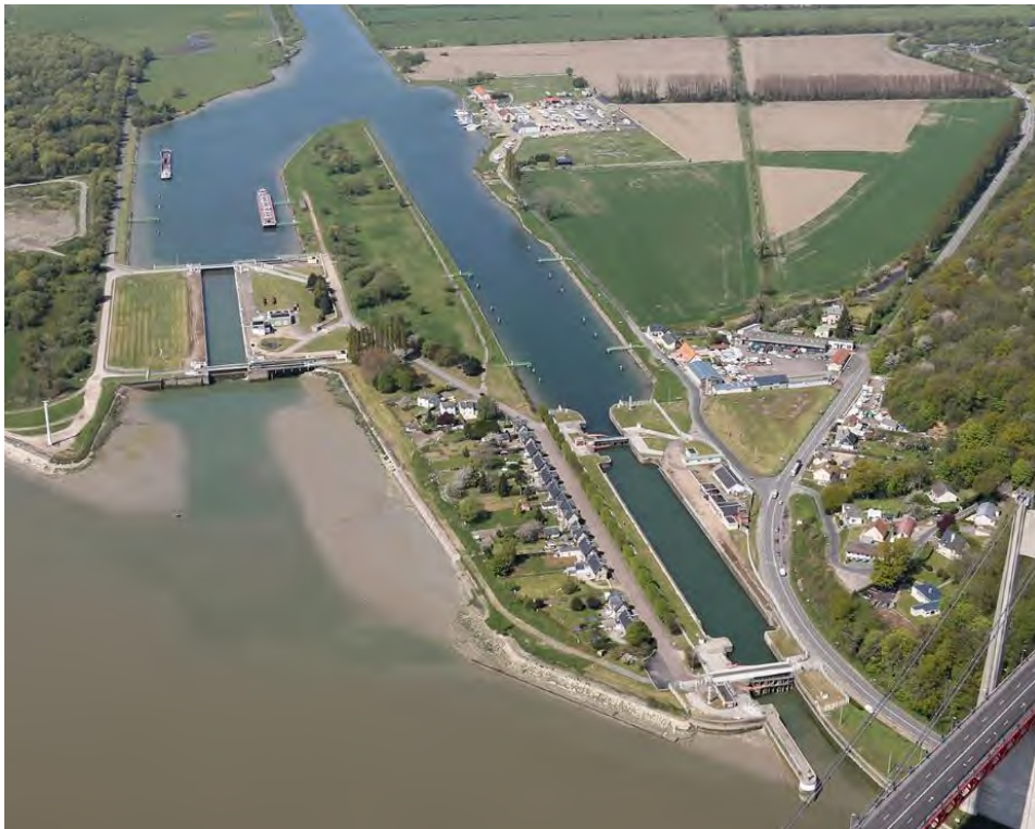
Les deux écluses de Tancarville (l'ancienne à droite datant de 1890 et mesurant 238 m de long sur 16 m de large ; la nouvelle à gauche construite en 1974 mesurant 203 m de long et 24 m de large)
