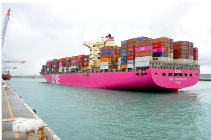
*Légende : Mis en service en 2008, le ONE Continuity est un porte-conteneurs de 320 mètres de long et 46 mètres de large ; sa capacité est de 8 110 evp*
